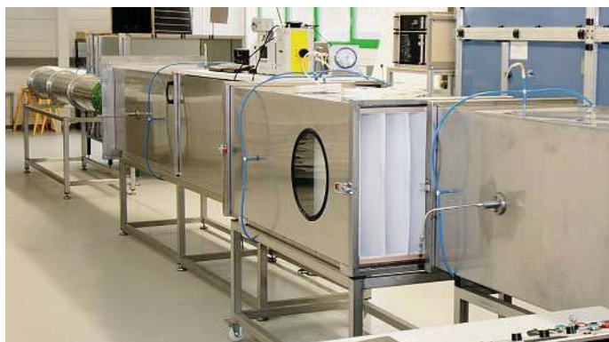
Prüfstand für Grob- und Feinstaubfilter nach EN779:2012.
