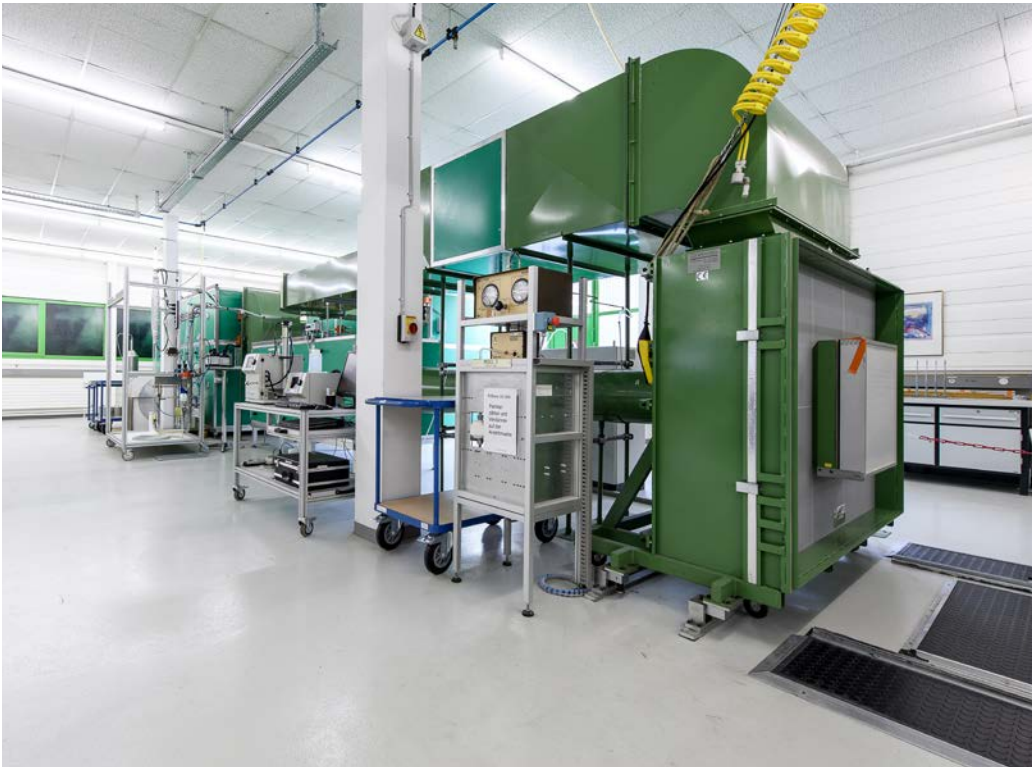
Scan-Prüfstand zur Filter-Leckprüfung nach ISO29463-4.
