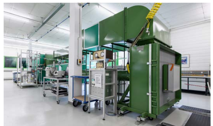
Optimal ausgerüstet: Scanner für Schwebstoff-Filterprüfungen nach EN1822/ISO 29463.
