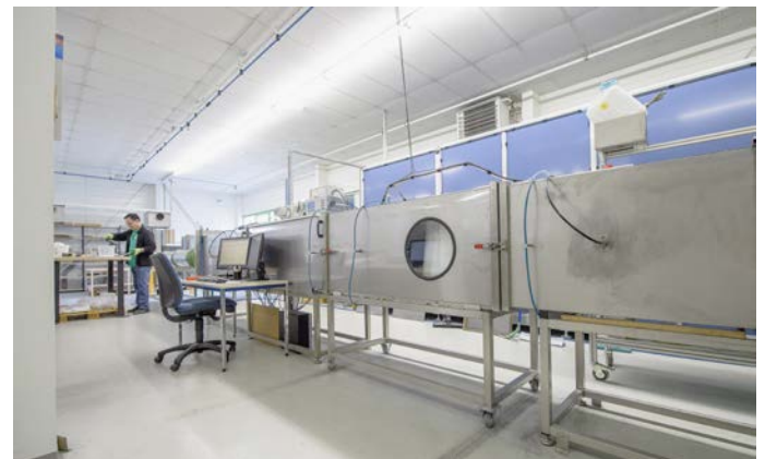
Prüfstand für Grob- und Feinstaubfilter nach ISO 16890.
