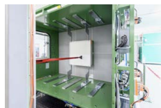
Scankopf von Scanner für Schwebstoff-Filterprüfungen nach EN1822/ISO 29463.
