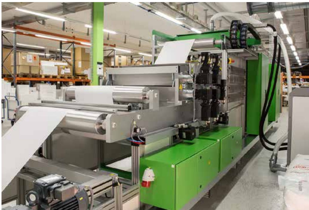
Permanente Modernisierung: neue Plissiermaschine zur Herstellung von plissierten Filterpaketen.
