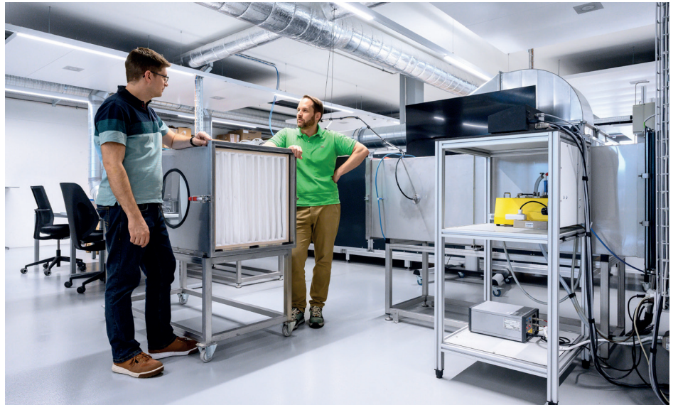
Felix Bots et Christian Sirtl devant le banc d'essai pour filtres à particules fines selon la norme ISO 16890
