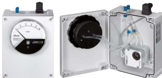
Der **A2G-90** ist eine Kombination aus mechanischem Analoganzeigegerät und Differenzdruckschalter, die in einem Kunststoffgehäuse eingebaut sind. Das Gehäuse ist aus Kunststoff PC/ABS 1625 (H x B x T = 240 x 191 x 110 mm) und mit allen Verbindungsanschlüssen ausgestattet. Der Deckel ist verschraubt. Die Schutzart ist IP 54. Der **A2G-90** eignet sich hervorragend zum Messen und Schalten von Über- und Differenzdruck in den Messbereichen 0 ... 250 bis 0 ... 6.000 Pa.
