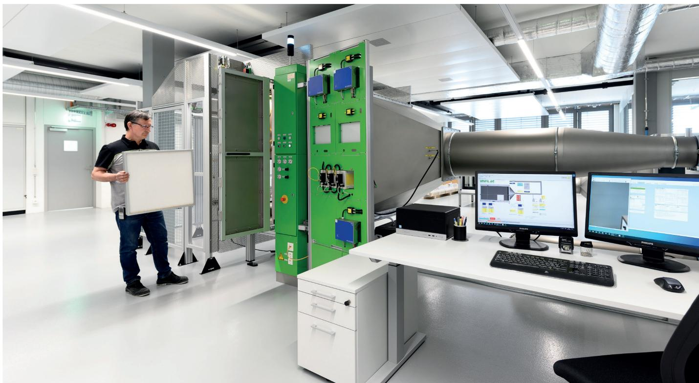
Scanner nach EN 1822/ISO 29463 für die Prüfung von Druckverlust, Gesamtwirkungsgrad und Leckfreiheit von Schwebstofffiltern der Klassen E10 bis U17.
