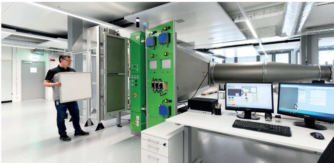
Scanner conforme à la norme EN 1822/ISO 29463 pour tester la perte de charge, l'efficacité globale et l'absence de fuites des filtres HEPA des classes E10 à U17.
